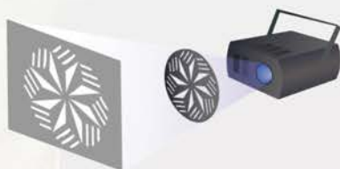
Prinzip der Schattenprojektion mit Gobos
